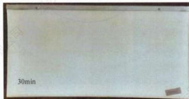
照片 2 耐高温性能试验结束时试件情况
